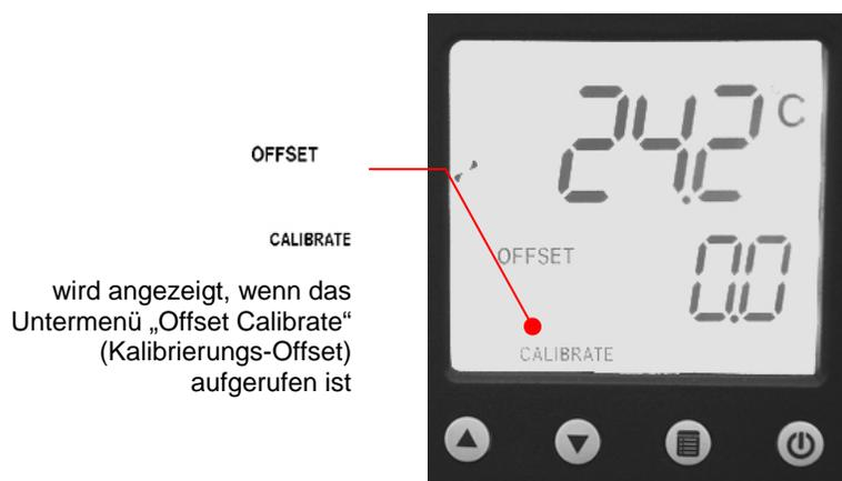
**Aufrufen:** Drücken Sie die Taste
